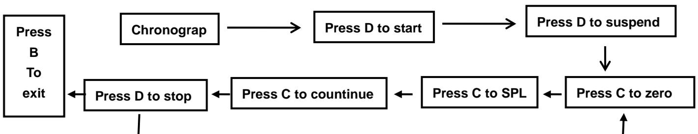
Press B to exit: Presion B para salir | Chronograp: Cronógrafo | Press D to start: Presiona D para iniciar | Press D to suspend: Presiona D para suspender | Press D to stop: Presiona D para detener | Press C to continue: Presiona C para continuar | Press C to SPL: Presion C para SPL | Press C to zero: Presiona C a cero
