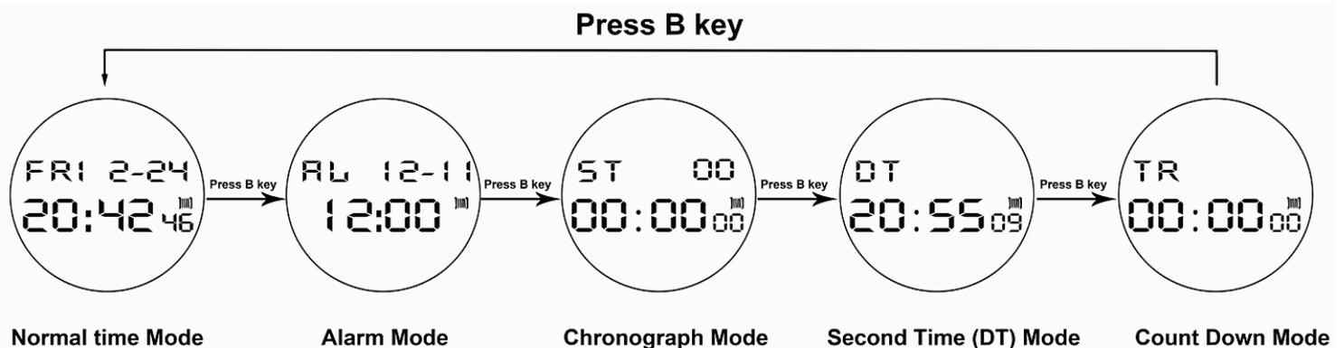
Press B Key: Presione botón B | Normal time mode: Modo tiempo normal | Alarm Mode: Modo Alarma | Chronograph Mode: Modo Cronógrafo | Second tiem (DT) Mode: Modo Segunda hora (DT) | Count Down Mode: Modo de cuenta regresiva
